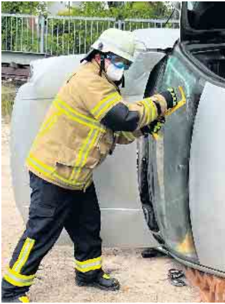
Mit Hilfe einer sogenannten Säbelsäge wurden die Autoscheiben aufgeschnitten, um Zugang zu den Verletzten zu schaffen. Foto: Feuerwehr Stadt Mechernich/pp/Agentur ProfiPress
