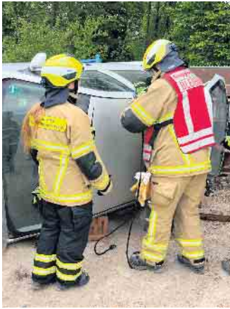
Hier bringen zwei Übungsteilnehmer eine Seilzug-Ratsche am Fahrzeug an. Sie dient zur Sicherung von beweglichen Teilen an Fahrzeugen oder Maschinen. Foto: Feuerwehr Stadt Mechernich/pp/Agentur ProfiPress
