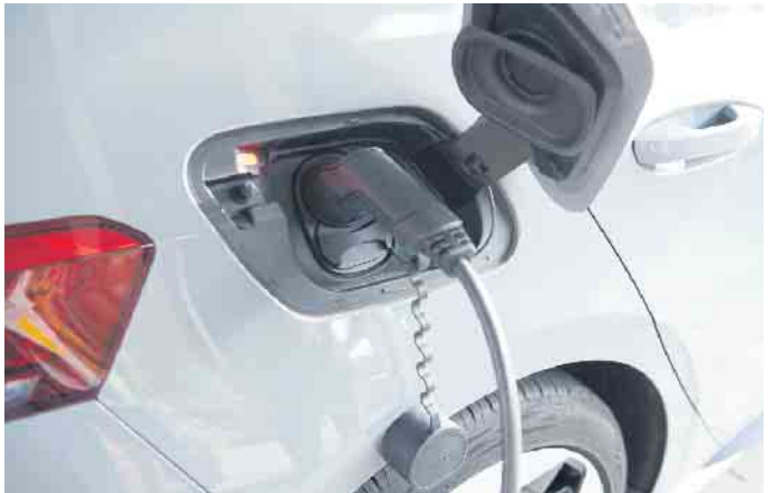
Anschluss in beide Richtungen. Beim bidirektionalen Laden dient die Batterie des E-Autos als zusätzlicher Energiespeicher für den Haushalt. Foto: DJD/E.ON/Malte Braun
