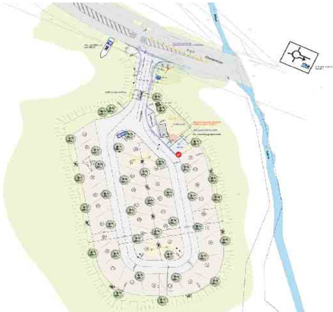
So sieht der Plan aus: Eine O-förmige Umfahrung führt zu den 36 Stellplätzen. Die Zufahrt wird über eine moderne Schranke geregelt, da der Buchungsprozess vollständig digitalisiert ist. Plan: Freizeit Mechernich GmbH/pp/Agentur ProfiPress
