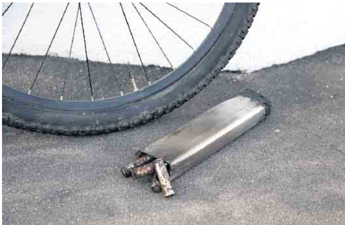
Das hätte auch ins Auge gehen können: ein zerstörter E-Bike-Akku. Foto: djd/Pentagon Sales
