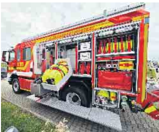
Das neue Löschgruppenfahrzeug LF 20 bietet Platz für eine neunköpfige Besatzung und verfügt über eine Motorleistung von 320 PS. Foto: Feuerwehr Stadt Mechernich/pp/Agentur ProfiPress
