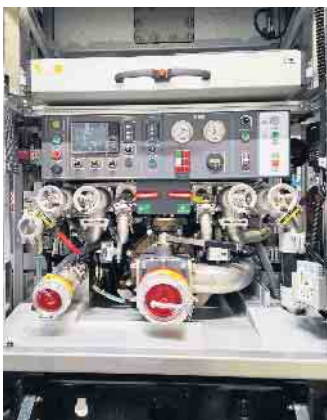
Ein Blick auf die Aggregate hinten: Zur umfangreichen Ausstattung des neuen Mechernicher LF 20 gehören unter anderem ein Löschwassertank mit 2.000 Litern Fassungsvermögen und ein zusätzlicher Schaummitteltank mit 200 Litern. Foto: Feuerwehr Stadt Mechernich/pp/Agentur ProfiPress
