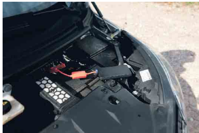
Akku-Booster in Aktion: Rote Polklemme an Plus, schwarze Polklemme an Minus, dann fließt der Strom. Foto: Pearl GmbH/www.pearl.de/mid/ak-o
