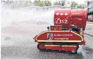
Das Löschunterstützungsfahrzeug LUF 60 im Einsatz.
