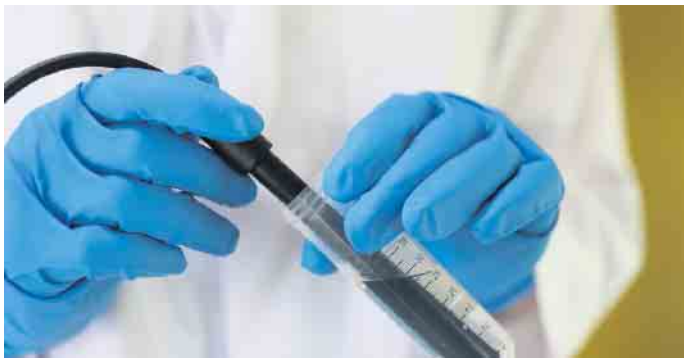
Spannender Einblick: bei der Probe wird die Leitfähigkeit des Wassers bestimmt
