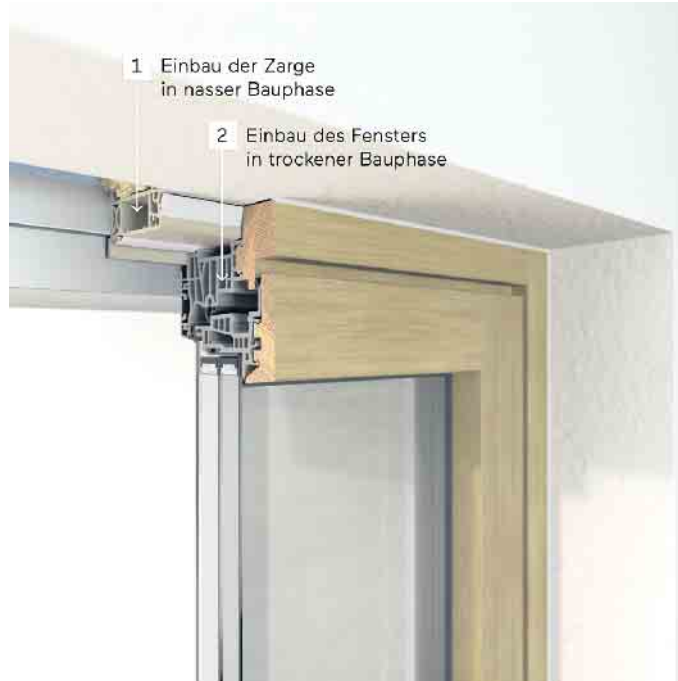
Ein zweistufiger Fenstereinstbau mit Einbaurahmen bietet viele Vorteile. Foto: © Finstral
