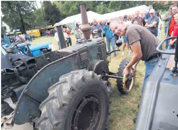
Den alten Lanz Bulldog mit dem Lenkrad anzukurbeln will gelernt sein und ist Schwerstarbeit.
