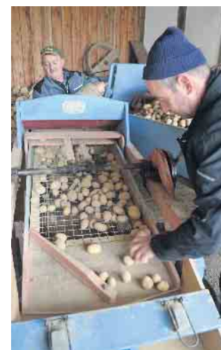
In der Sortiermaschine werden Kartoffeln nach Größe sortiert.
