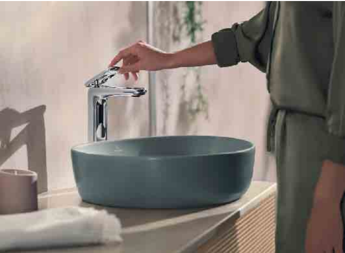
Einhebelmischer am Waschtisch oder in der Dusche eignen sich gut zum Energiesparen, da hier die gewünschte Temperatur zügiger eingestellt werden kann als mit Zweigriffarmaturen. Foto: Villeroy & Boch/Antao/akz-o
