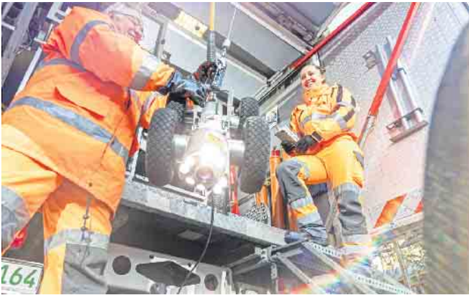
Hightech im Kanal: Ferngesteuerte Kameraroboter liefern scharfe Bilder, die anschließend mit KI-Unterstützung ausgewertet werden. Foto: DJD/VDRK/Sascha Kreklau
