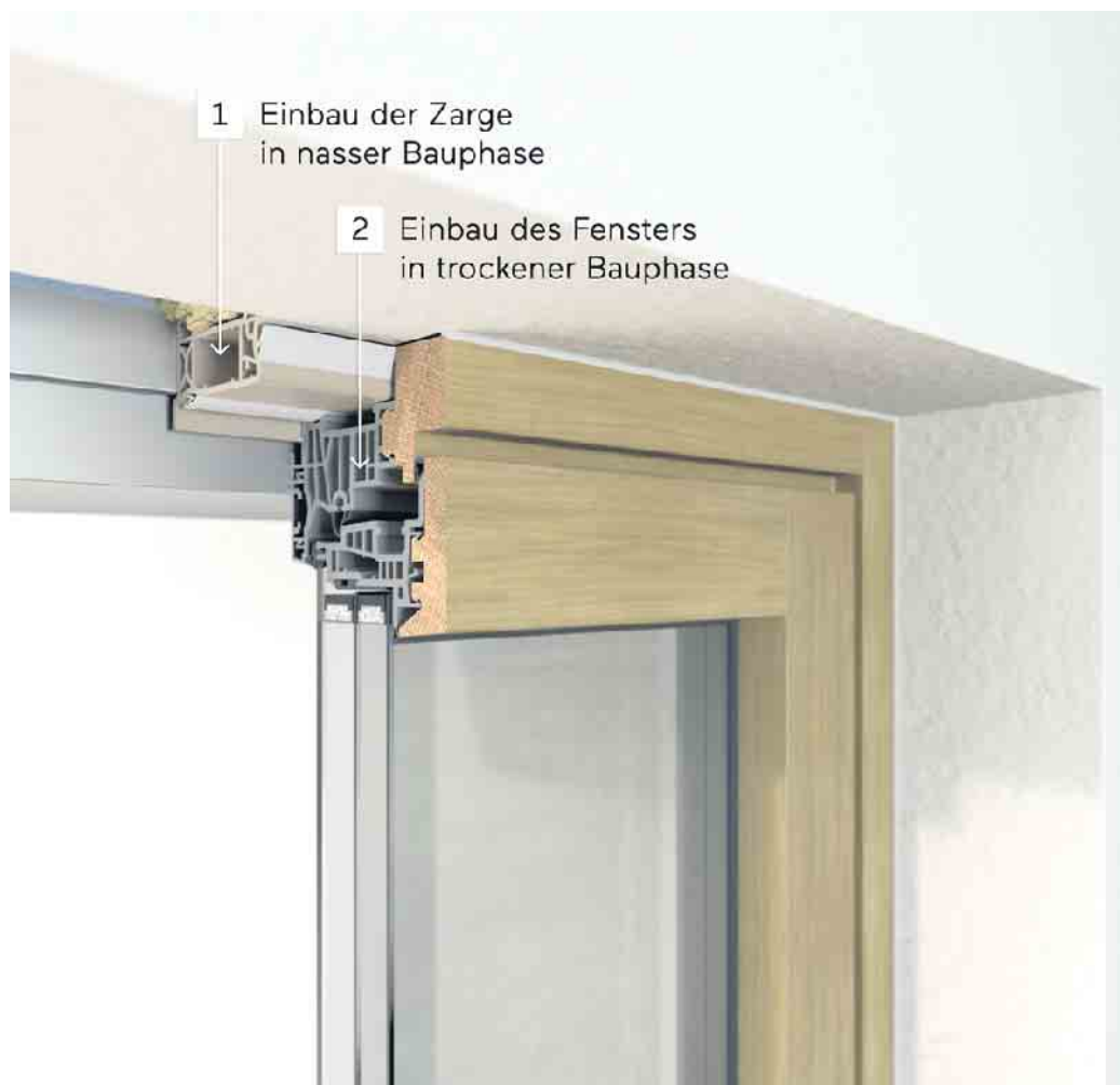
Ein zweistufiger Fenstereinbau mit Einbaurahmen bietet viele Vorteile.
