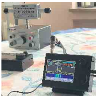
Ein digitaler Kurzwellenempfänger und eine Ferrit-Spezialantenne machen den Empfang auf 17,2 kHz möglich. Foto: OV G26
