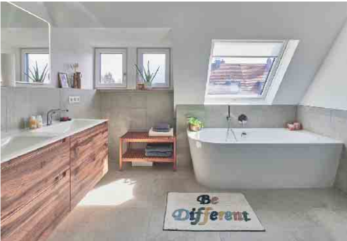
Dachfenster (rechts) und Gaube (links) in diesem Badezimmer zeigen den Unterschied: Während durch die Gaube mehr Wohnfläche mit voller Stehhöhe gewonnen wird, sorgt das Dachfenster für einen deutlich höheren Tageslichteinfall. Foto: Velux/Michael Christian Peters/akz-o
