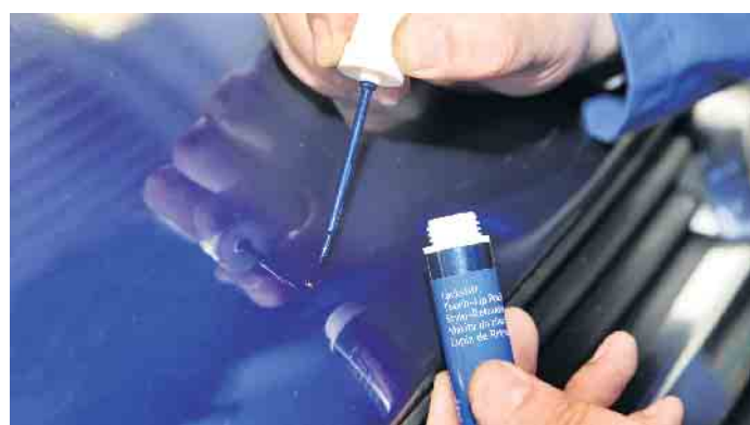
Kleine Steinschläge im Lack lassen sich per Smart-Repair unsichtbar machen. Foto: djd/Kfzgewerbe
