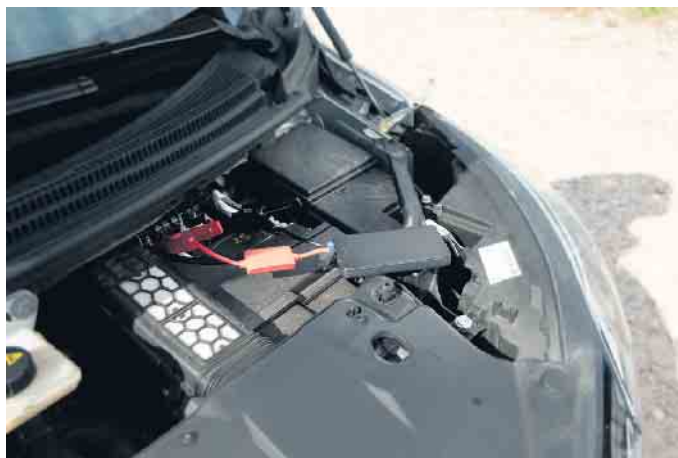
Akku-Booster in Aktion: Rote Polklemme an Plus, schwarze Polklemme an Minus, dann fließt der Strom.
