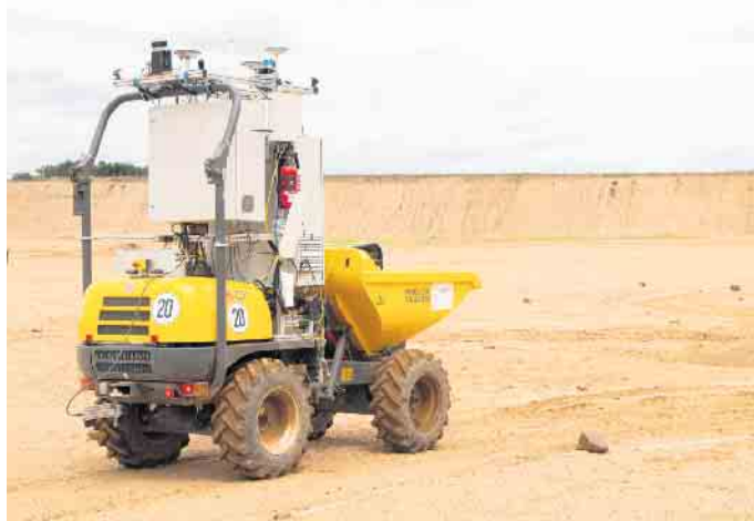
Der autonome Bergbau-Muldenkipper kann über und auch unter Tage arbeiten
