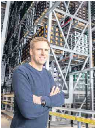
Die Hochregallager in der Brauerei haben eine Höhe von bis zu 35 Metern und umfassen 41.000 Palettenstellplätze. Foto: DJD/Veltins
