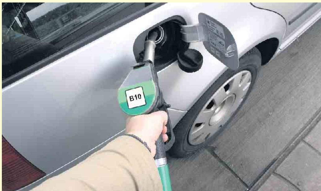
Seit April 2024 kann der neue Kraftstoff B10 an Tankstellen in Deutschland angeboten werden. Mit B10 wird ein Dieselkraftstoff bezeichnet, dem bis zu zehn Prozent Biodiesel beigemischt werden. Foto: DJD/Verband der Deutschen Biokraftstoffindustrie
