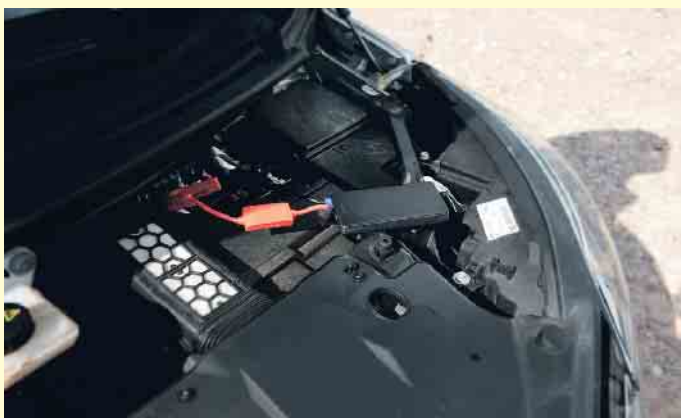
Akku-Booster in Aktion: Rote Polklemme an Plus, schwarze Polklemme an Minus, dann fließt der Strom. Foto: Pearl GmbH/www.pearl.de/mid/ak-o
