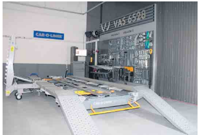
Die moderne Richtbank der Autolackiererei Hegger in Oberpleis - präzise Karosserieinstandsetzung für perfekte Fahrzeuggeometrie
