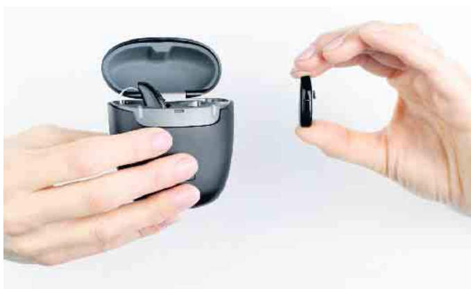
Mit einem transportablen Akku können die Hörgeräte aufgeladen werden - er dient gleichzeitig zur Aufbewahrung. Foto: djd/audibene
