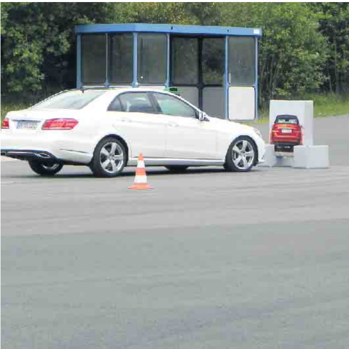
Der Notbremsassistent warnt den Fahrer vor Kollisionen und hilft in kritischen Situationen, bestmöglich zu bremsen. Er ist jederzeit aktiv und kann heikle Situationen erkennen. Foto: djd/Deutscher Verkehrssicherheitsrat
