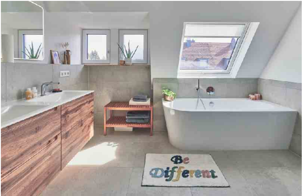
Dachfenster (rechts) und Gaube (links) in diesem Badezimmer zeigen den Unterschied: Während durch die Gaube mehr Wohnfläche mit voller Stehhöhe gewonnen wird, sorgt das Dachfenster für einen deutlich höheren Tageslichteinfall. Foto: Velux/Michael Christian Peters/akz-o
