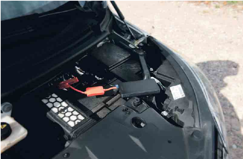
Akku-Booster in Aktion: Rote Polklemme an Plus, schwarze Polklemme an Minus, dann fließt der Strom. Foto: Pearl GmbH/www.pearl.de/mid/ak-o
