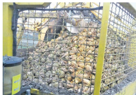
Mit Förderschnecken werden die geernteten Zuckerrüben in die Lagerboxen befördert, ohne die Frucht zu beschädigen – hier der Blick aus der Fahrerkabine.
