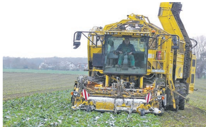
Die selbstfahrende Erntemaschine nimmt in voller Breite die Rüben aus der Erde, schneidet sie fachgerecht ab und befördert sie in die Lagerbox.
