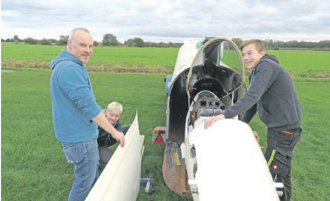
Ohren anlegen für die Winterpflege: Für Werkstattarbeiten oder nach Außenlandungen werden Segelflugzeuge abgerüstet. Mit ein paar Handgriffen werden die Tragflächen vom Rumpf getrennt und im Anhänger verstaut. Foto: Friedrich Lücke
