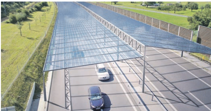
Visualisierung einer Straßenüberdachung mit Photovoltaik. Quelle: Fraunhofer ISE Projekt PV-Süd
