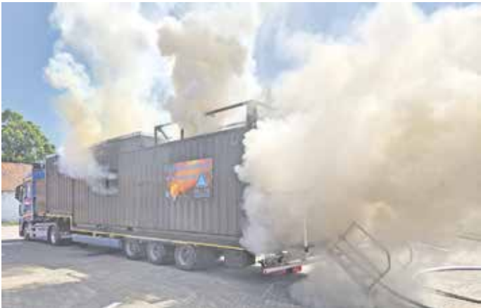
Eine Rauchgasdurchzündung, während sich die Atemschutzgeräteträger im Brandcontainer befinden
