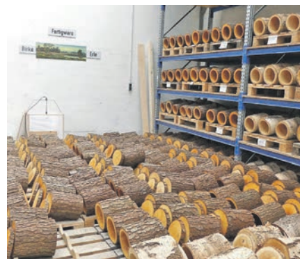
Fertige Urnenhüllen mit einem passenden Holzdeckel werden langsam getrocknet, so dass der Holzkern nicht reißt.
