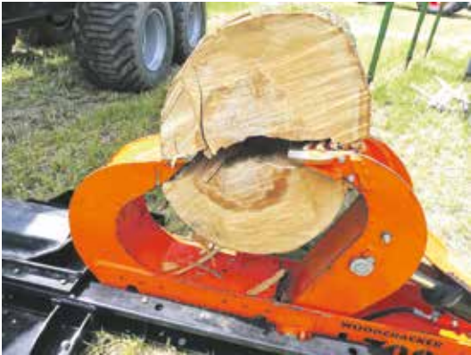
Ein „dicker“ Holzstamm, Durchmesser ca. 1,00 m oder mehr, kann für die weitere Verarbeitung mit hydraulischer Kraft etwa mittig gespalten werden mit dem „Woodcracker“.
