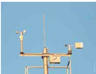
Eine Wetter- oder Klimastation misst Niederschläge, Temperaturen und Luftdruck.
