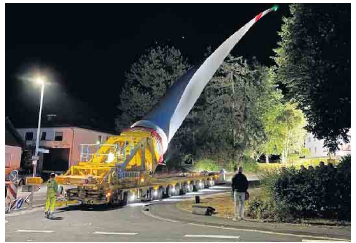
Mit Fernsteuerung und in „Millimeterarbeit“ wird der Selbstfahrer durch die enge Einbiegung gesteuert. © Gemeinde Dahlem
