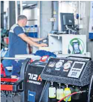
Mechaniker mit Sachkundenachweis für die Klimaanlagenwartung und professionelle Klimaservicegeräte stellen sicher, dass bei der Überprüfung der Fahrzeugklimatisierung nichts übersehen wird. Foto: DJD/Kfzgewerbe/Heike Wippermann
