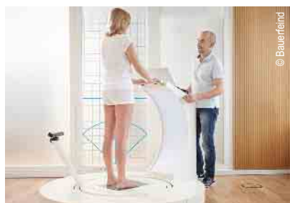
3D-Vermessung für Kompressionsstrümpfe und orthop. Einlagen
