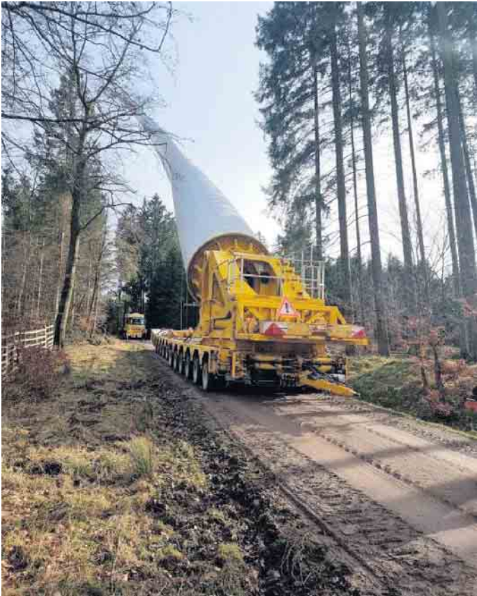
Mit dem Selbstfahrer können die Rotorblätter auch über die schmalen Waldwege transportiert werden. © Bohnen
