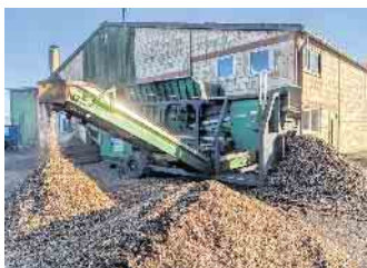
Das Sternsieb ist das Herzstück des Betriebs. Es sortiert die Holzreste in einheitliche Gruppen.
