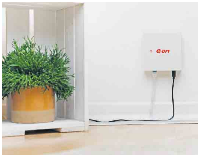
Die kompakte Box dient als Steuerzentrale und verknüpft bestehende Energielösungen wie Photovoltaik, Batteriespeicher oder Wärmepumpe zu einem effizienten System. Foto: DJD/E.ON/Max Kruse
