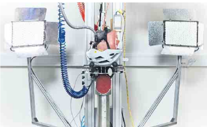
Helme werden in der Regel nur darauf geprüft, ob sie einem geraden Aufprall standhalten. Meist erfolgt der Aufprall jedoch schräg, was gefährliche Rotationsbewegungen verursachen kann. Foto: DJD/ www.mipsprotection.com/Mips_AB
