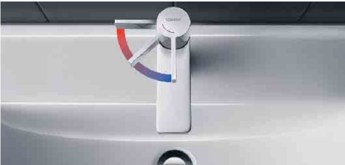
Die energiesparende FreshStart-Funktion bei Einhebelmischern sorgt dafür, dass die Beimischung von Heißwasser erst erfolgt, wenn der Hebel bewusst nach links bewegt wird. Foto: Duravit/FreshStart/akz-o
