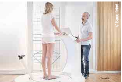
3D-Vermessung für Kompressionsstrümpfe und orthop. Einlagen
