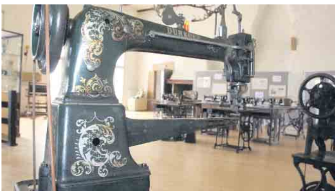
Diese Schuster-Nähmaschine der Firma Dürkopp von 1931 durchsticht auf zähstes Leder.
