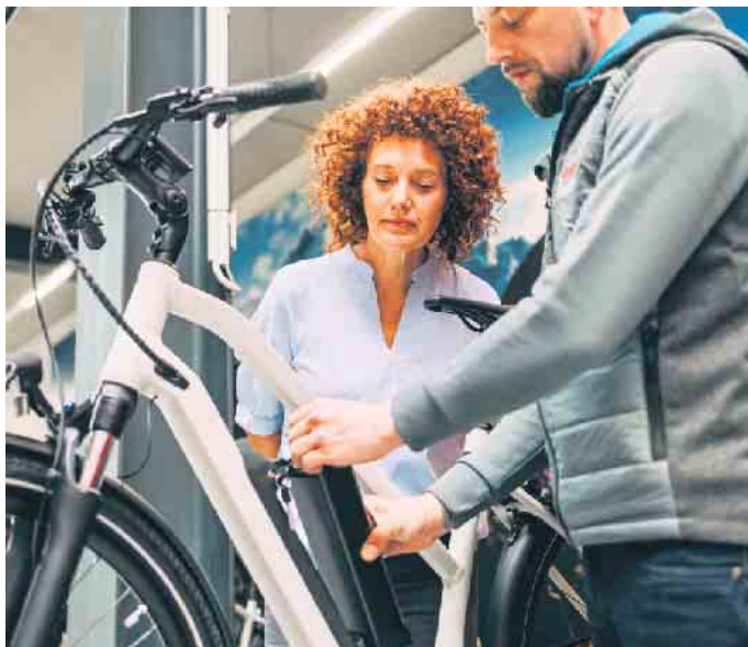
Vor der Winterpause sollte das E-Bike gründlich gewartet werden. Tipp: Den Akku abnehmen und separat an einem trockenen Ort ohne große Temperaturschwankungen lagern. Foto: DJD/Robert Bosch
