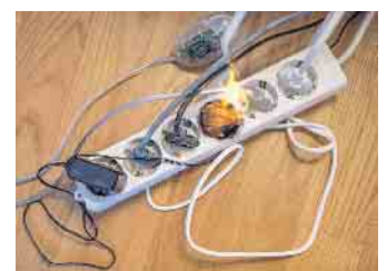
Brennende Steckerleiste durch Kurzschluss
