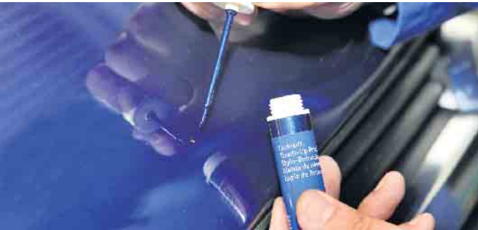
Kleine Steinschläge im Lack lassen sich per Smart-Repair unsichtbar machen. Foto: djd/Kfzgewerbe
