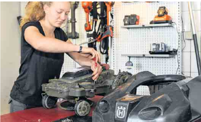
Bei mechatronischen Berufen stehen Wartung und Reparatur von Garten- und Outdoorgeräten im Mittelpunkt. Foto: DJD/www.greenbase.de/ Lisa Schaetz
