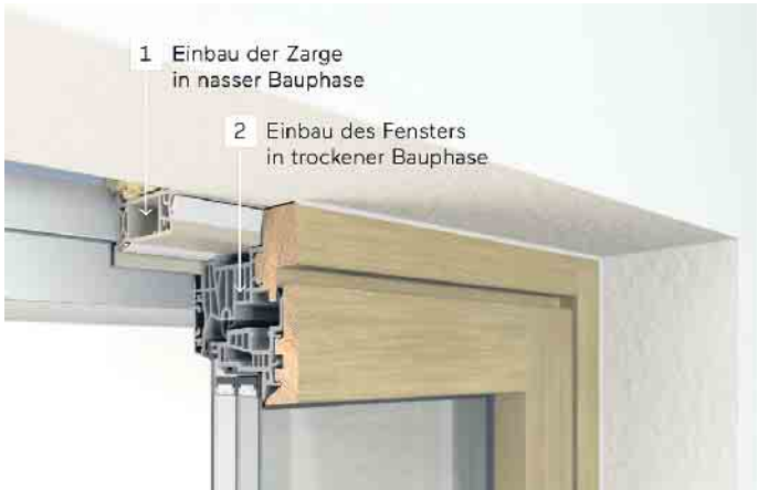
Ein zweistufiger Fenstereinbau mit Einbaurahmen bietet viele Vorteile. Foto: © Finstral
